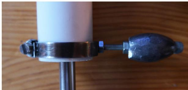
Mettre l'axe de rotation horizontal, et déplacer le plomb pour arriver à l'équilibrage parfait.
